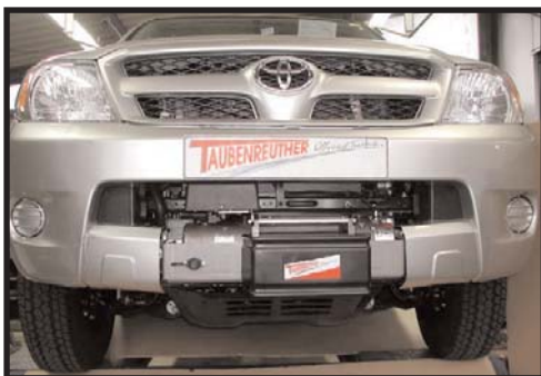
Bildet over illustrerer en skjult montering som beholder bilens originale støtfanger.
