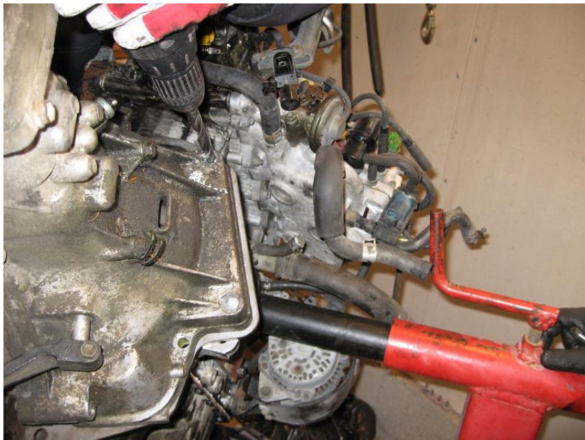
Borring av øvre hull i girkasse.
