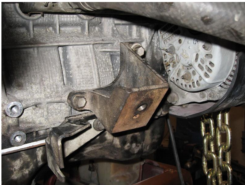
Venstre motorfeste og brakett til clutchvaier.
