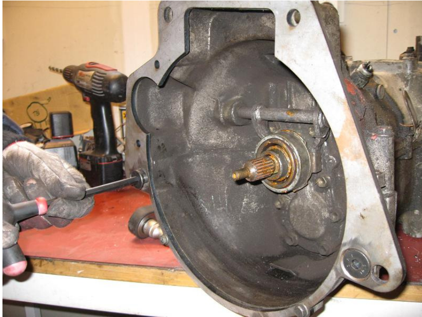
Påmontert adapterplate på 1300 girkassa med nedsenkede 12mm unbrakoskruer.
