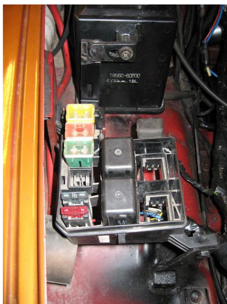
Rød 10A sikring foran A26 på ECM.
