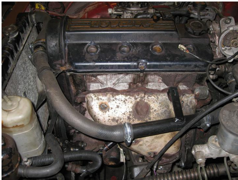
Radiator og kjølerør fra høyre side.
