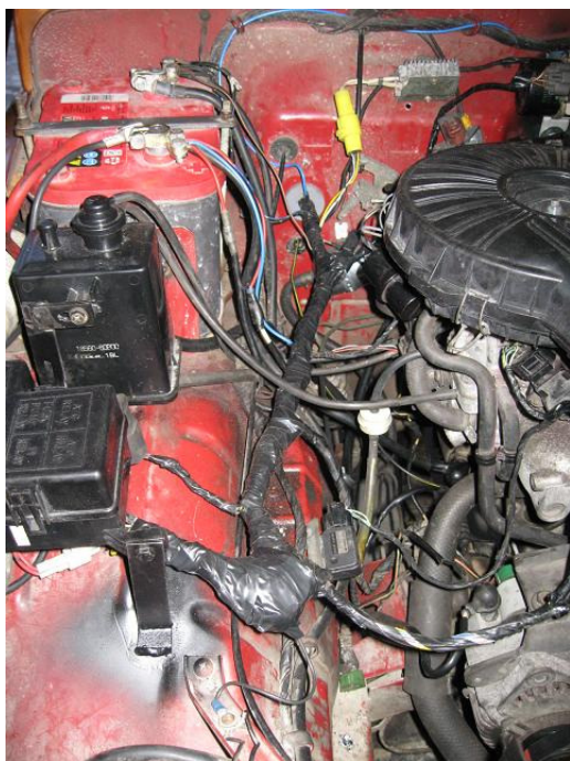
Ledningsnett og gjennomføring til kupe.
