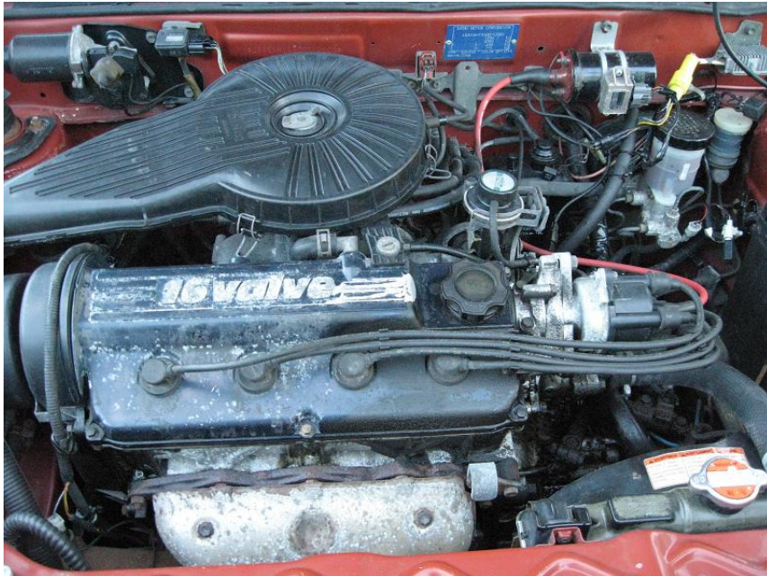
Tverrstilt motor i Swift'en med horisontal fordeler.
