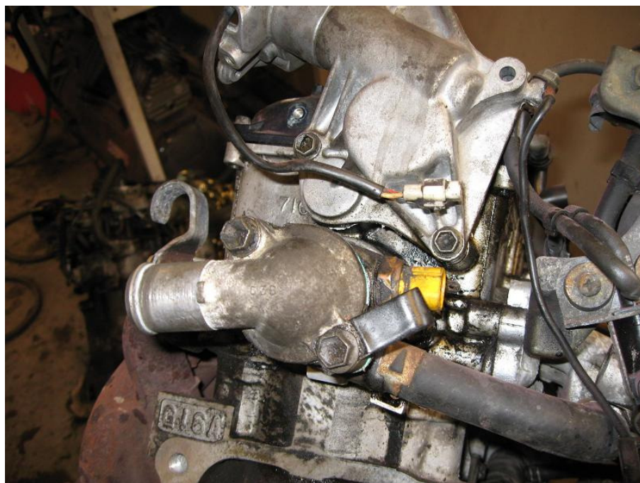
Termostathus fra 1300 montert på 1600 motor.
