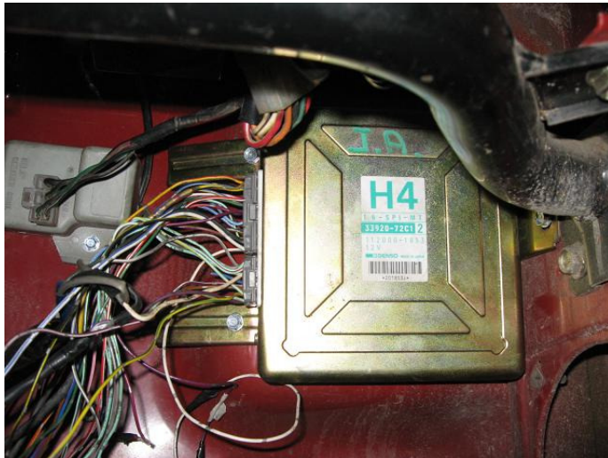
Plassering av ECM under hanskerom. Mangler litt tejp og finish her.
