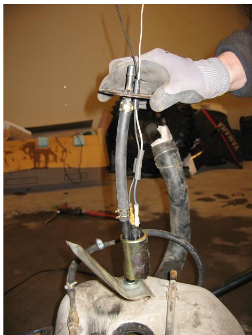
Modifisert bensinpumpe til SJ tanken.
