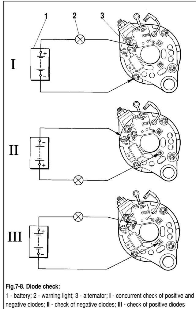
**Fig.7-8. Diode check:**
